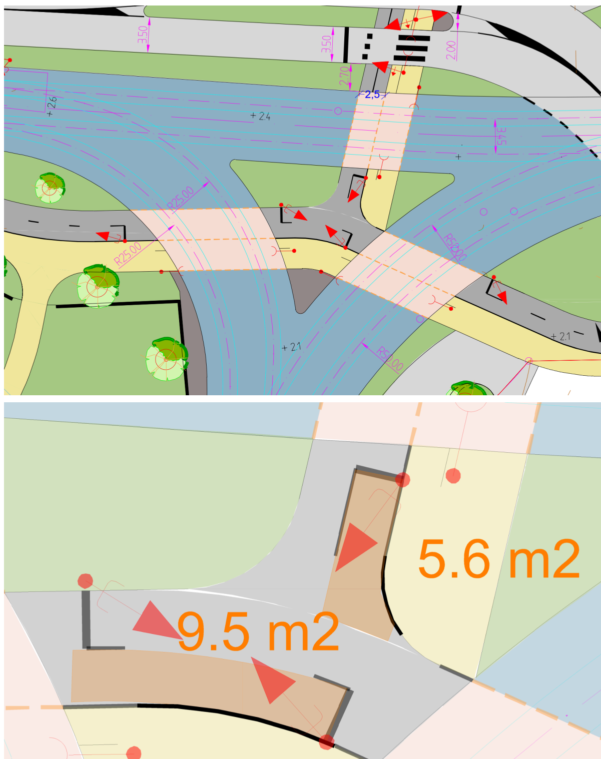
Figur 4: Över: en översiktsbild över cykelvägens dragning och väntyterna mitt i spårvägs korsningen. Under: Tillgänglig yta för cyklister att vänta på.
