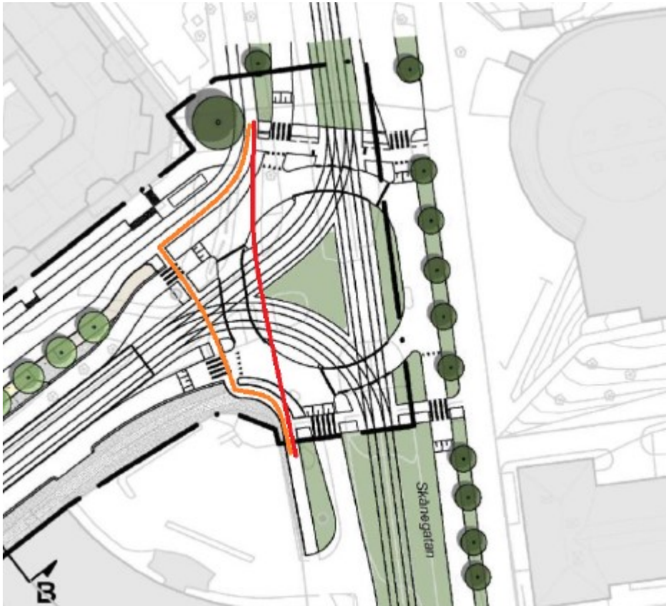
Från detaljplanens illustrationsritning. Röd linje visar dagens cykelbana och orange visar förslaget med skarpa svängar.
